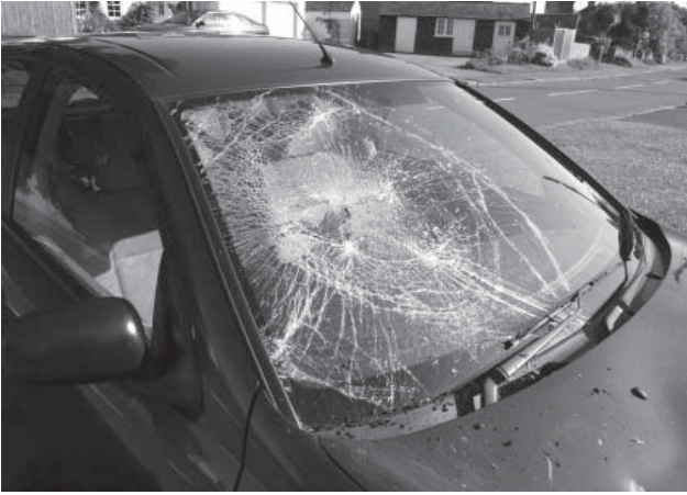
चित्र-2: काँच को अधिक मज़बूत बनाने और उसे तीखे टुकड़ों में टूटने से बचाने के लिए प्लास्टिक का उपयोग किया जाता है। इससे काँच पर सिर्फ दरारें आती हैं और काँच बिखरता नहीं है।
